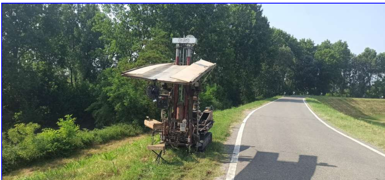
Foto 51 Prova CPT – Ced. Tratto Copermio
