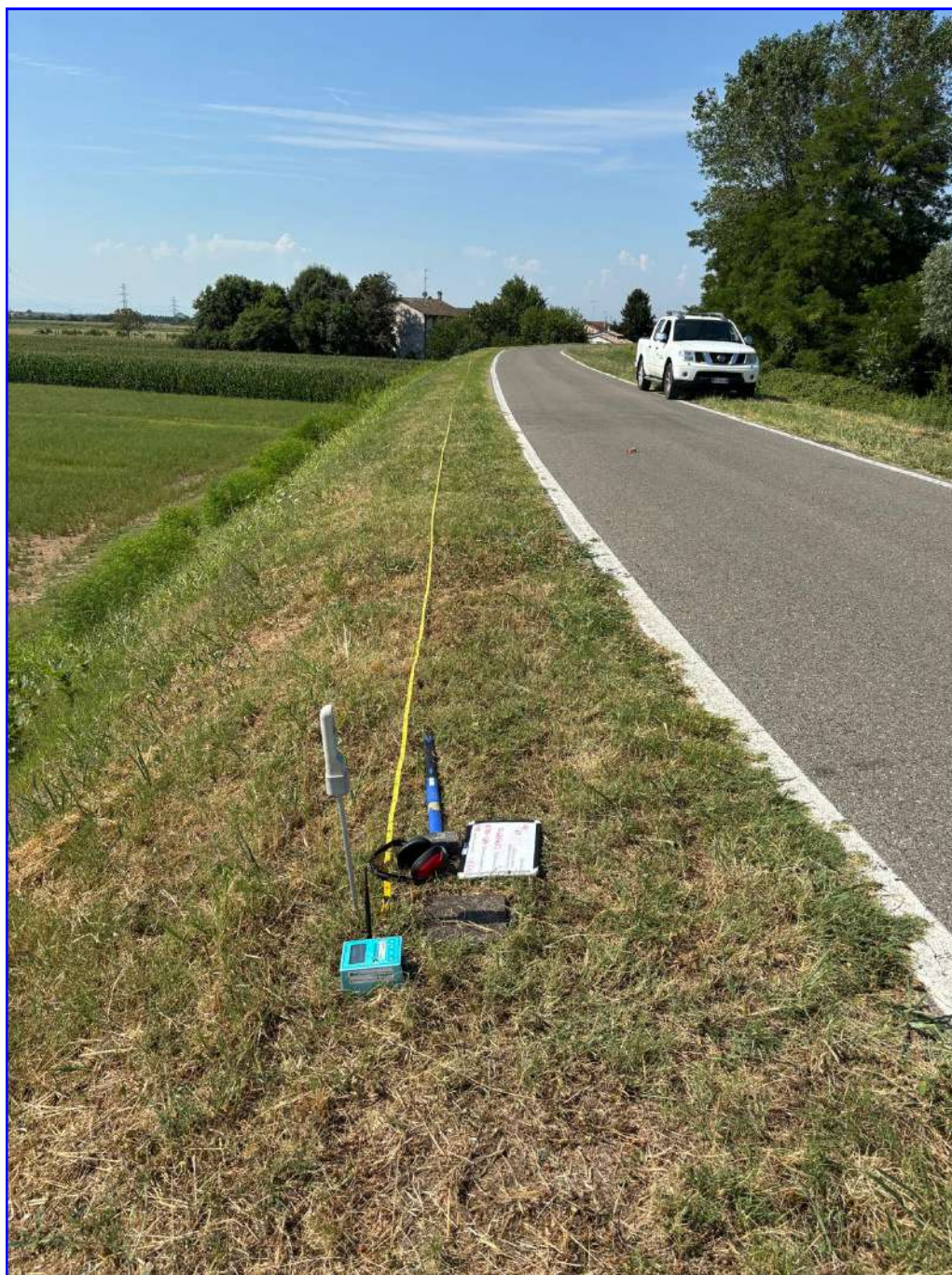
Foto 48 Prova MASW – Ced. Tratto Copermio
